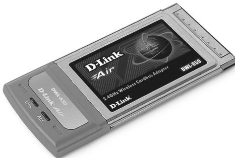
Bild 2.9 ~ Am häufigsten kommen in Notebooks WLAN-Cardbus-Adapter wie der D-Link_DWL-610 zum Einsatz.
