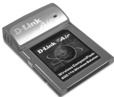
Bild 2.11 ~ WLAN-CF-Adapter wie der D-Link DCF-660w sind die einzige Möglichkeit, einen WLAN-losen PDA in ein Funknetz einzubinden.
